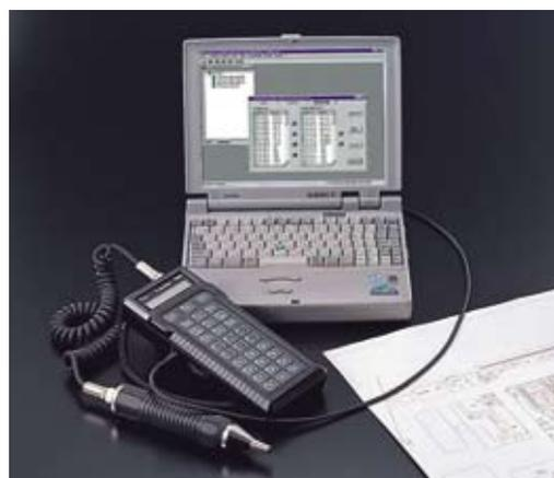
**TrapManager** permite que você determine antecipadamente a rota de inspeção. Com isso, um simples download, estes dados são transferidos ao **TM5**. Quando completada a inspeção de um purgador, o número do próximo purgador a ser inspecionado aparece na tela do **TM5**
